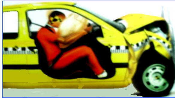
Şekil 3.1: Çarpışma testiyle darbe etkilerinin belirlenmesi
